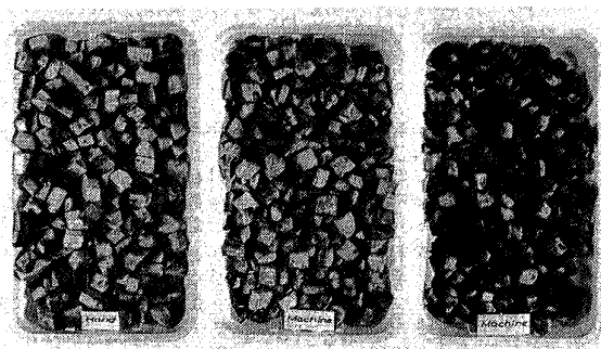
In blokjes gesneden knolselderij; links: met de hand gesneden, midden: gesneden met een snijmachine met scherpe messen, rechts: gesneden met een snijmachine met minder scherpe messen
